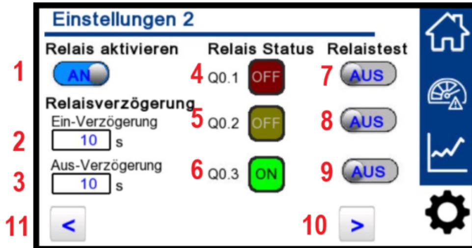
**i** Der Status, welches Relais geschaltet ist (**4** rot, **5** gelb, **6** grün), hängt ausschließlich vom aktuell gemessenen Staubwert ab. Die Messwerte von Temperatur und Luftfeuchtigkeit haben für den Status der Relais keine Bedeutung. Dies macht Sinn, da die Ansteuerung einer Luftfilteranlage Einfluss auf die Staubbelastung in der Luft hat, nicht aber auf Temperatur oder Luftfeuchtigkeit.
